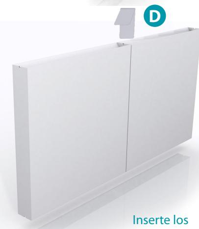
Inserte los conectores en "V" de las cajas Pibox centrales del portal
